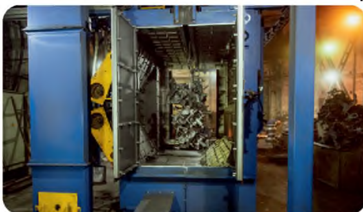
Очистка литья в дробемете проходного типа
