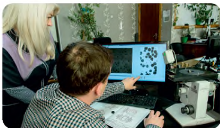
Металлографический микроскоп с программой анализа изображений Image Expert Sample 2
