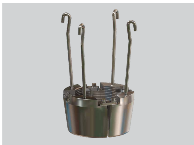
Первичное уплотнение обсадной трубы с предварительной активацией на рабочее давление от 70 до 105 МПа
